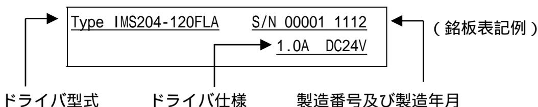
上記の銘板は、ドライバ型式：IMS204-120FLA、製造番号：00001、製造年月：2011年12月、仕様：定格電流1.0A 電源DC24Vを表します。
